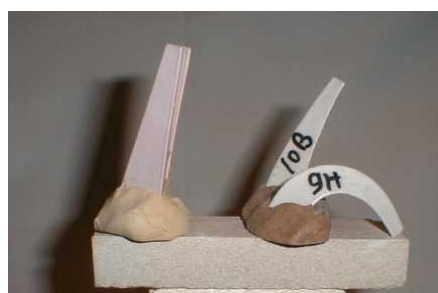
Cônes 9 et 10, avant et après cuisson. Après cuisson (à droite), le cône 9H est tombé, le cône 10B est penché.
